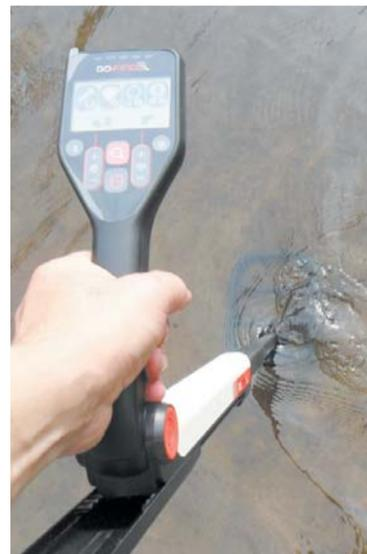
уровня минерализации грунта появляются ложные срабатывания и т. п., чувствительность занижается до комфортного уровня. Но вообще-то Minelab Go-Find — приборы весьма и весьма стабильные. Соответственно, и уровень чувствительности в подавляющем большинстве случаев предельно возможный. А это в свою очередь обеспечивает максимальную глубину обнаружения целей в грунте.
